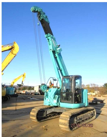
クローラクレーン
